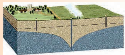
شکل ۲- چاه بهره برداری
